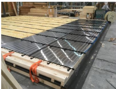
Vorfabrikation in Werkhalle. Holzrahmenelemente mit Absorber.
